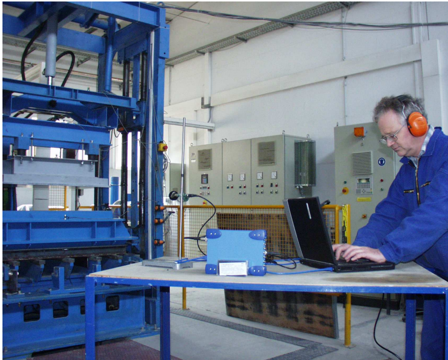
Bild: Schallmessung an einem Steinfertiger mit einem OROS OR34 Multi-Analysator
