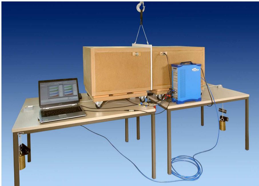
Bild: Bauakustischer Modellprüfstand im Maßstab 1:8 mit eingebautem Trennbauteil und dem eingesetzten OR 38 System
