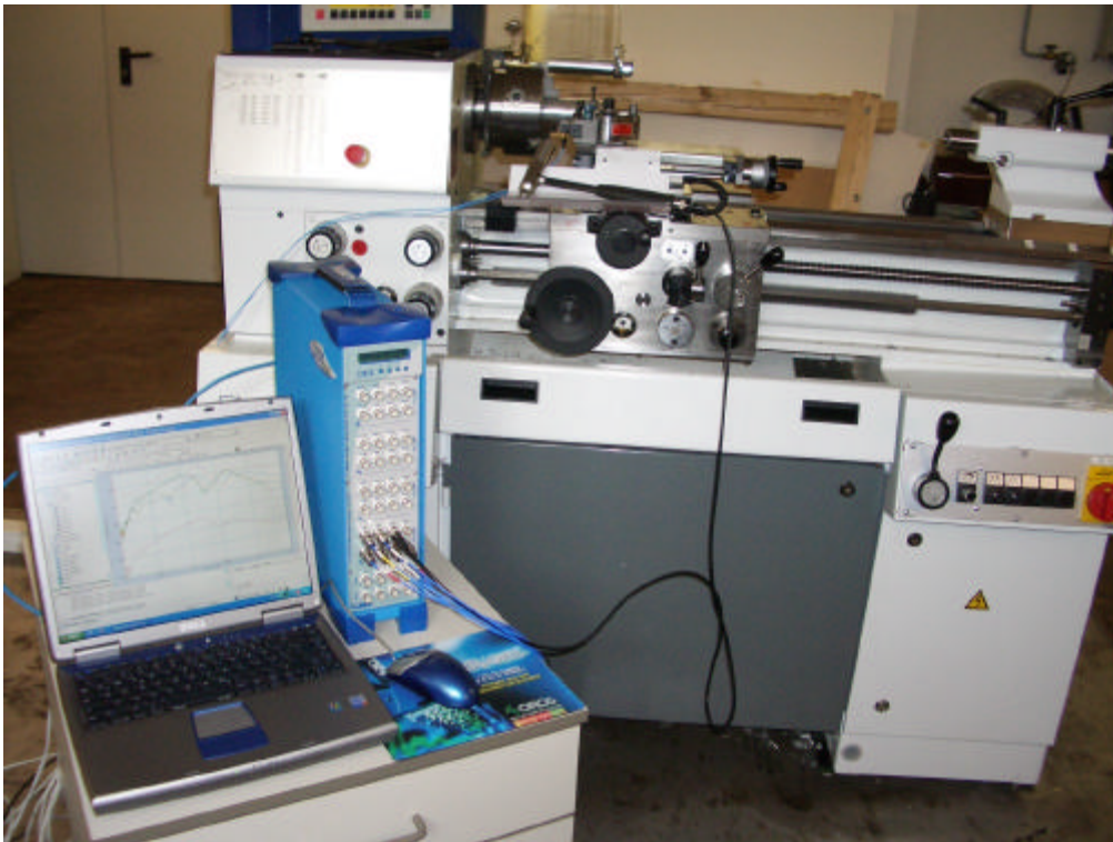
Bild: Schwingungsmessungen an einer Drehmaschine
