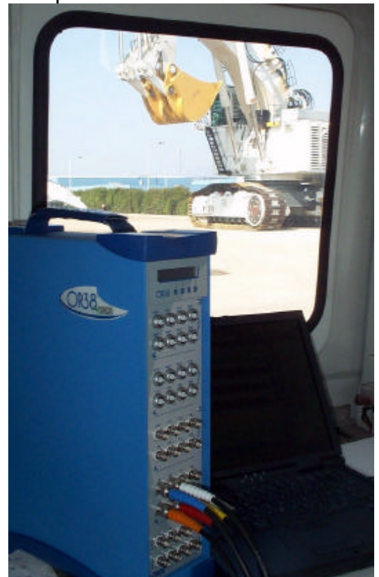
Bild 6: Schalleistungsmessung mittels Schalldruck an einem Großbagger
